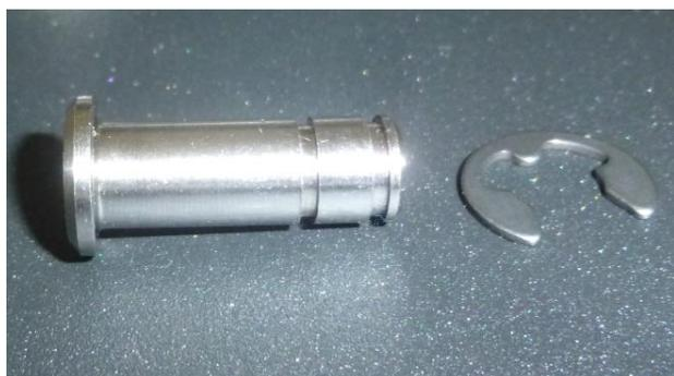
3. Pour la liaison de brin d'entraînement avec les embouts des lames et le support du moteur, utilisez les boulons du support principal et deux petites bagues de retenue. Le boulon possède deux rainures : une rainure à la fin sert à la fixation avec le support du moteur. Une rainure plus loin de la fin doit être utilisée pour les autres embouts d'entraînement (sans support du moteur) – fig. 13
