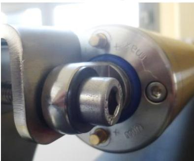
8. Effectuez la connexion électrique du moteur. Utilisez le câble de commande pour ouvrir et fermer les lames deux fois.
