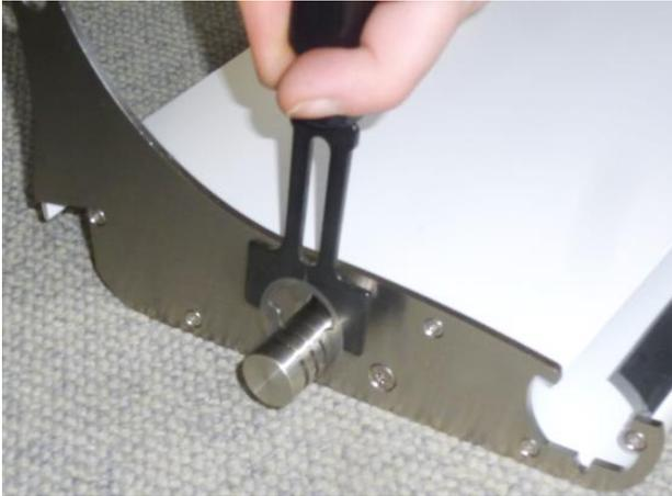
1. Aux boulons du côté d'entraînement mettez les grandes bagues de retenue dans la deuxième rainure de la surface de bouchon – répétez l'opération pour toutes les lames de même côté et dans la même rainure. (fig. 21)
